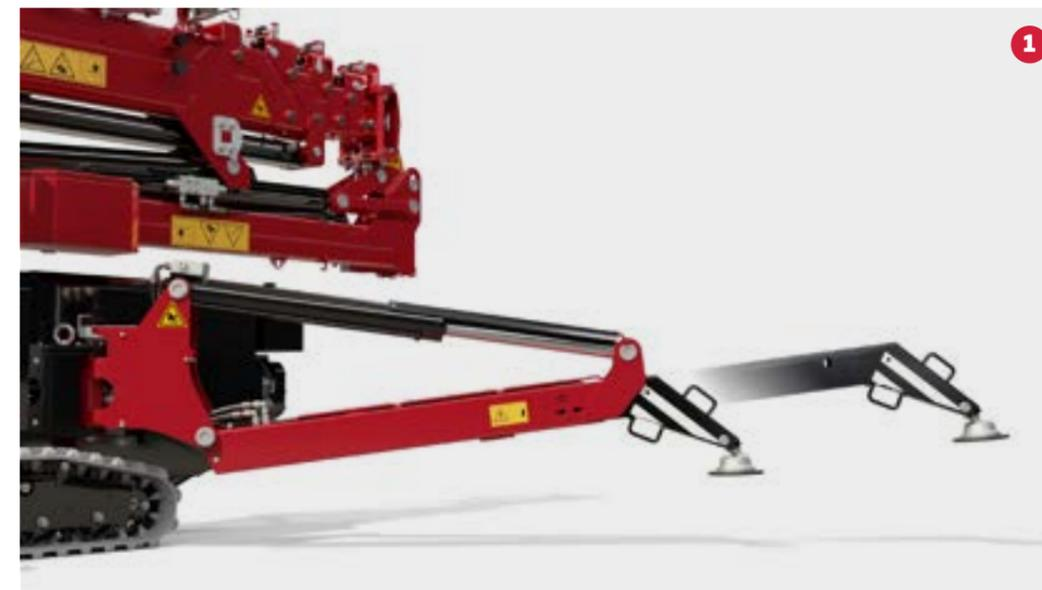
**1 Hydraulisch ausfahrbare Stützbeine**
